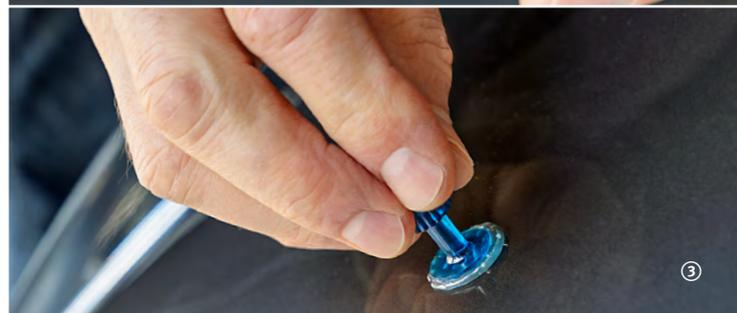
Zudem muss bei der Anwendung auf eine angemessene Temperatur geachtet werden. Die Temperatur des Blechs sollte ca. 20-24 Grad aufweisen; darunter ist das Blech zu hart und der Lack zu spröde, darüber bleibt der Kleber ggf. zu weich und kann die Kraft nicht übertragen.
