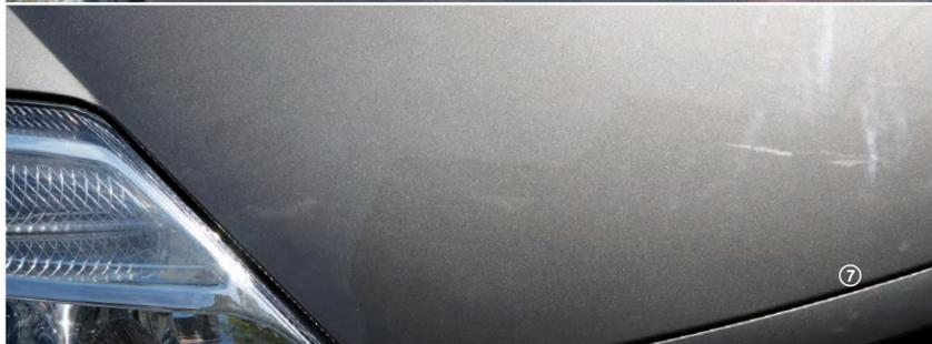
Um Spannung abzubauen, kann man das Blech immer wieder vorsichtig mit dem kleinen Gummihammer bearbeiten. Man klopft dabei mit sehr vielen, leichten Schlägen vom Rand der Delle aus ins unverformte Blech.
